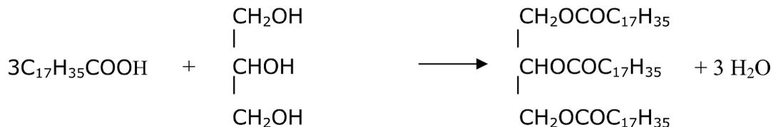
C'est une réaction d'estérification. Elle est lente, athermique et limitée (par la réaction inverse). (01,5 point)
