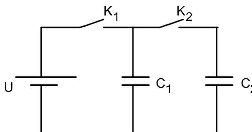
l'interrupteur  $K_1$  et on ferme l'interrupteur  $K_2$ . Le condensateur de capacité  $C_2$  est initialement non chargé. 2.a- Calculer la charge finale de chaque condensateur.
