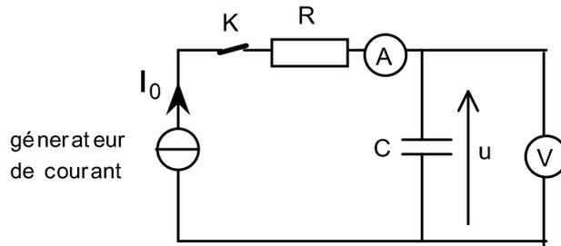
On mesure la tension aux bornes du condensateur en fonction du temps. On obtient les résultats suivants :
